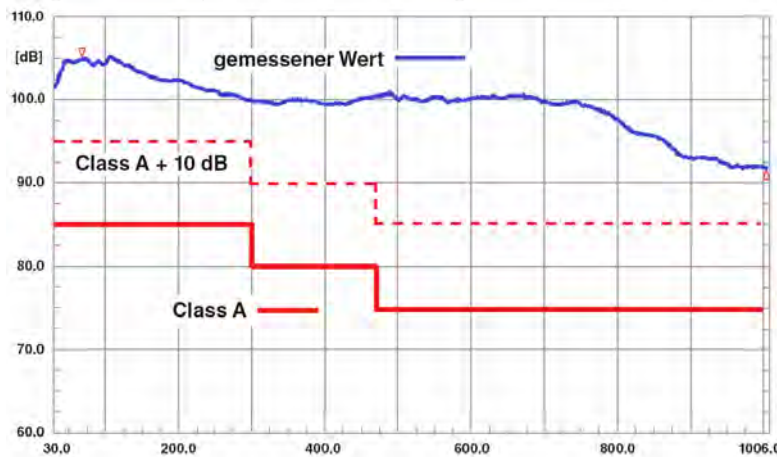
EMV Messung am neuen GUT-Anschlussdosenchassis
